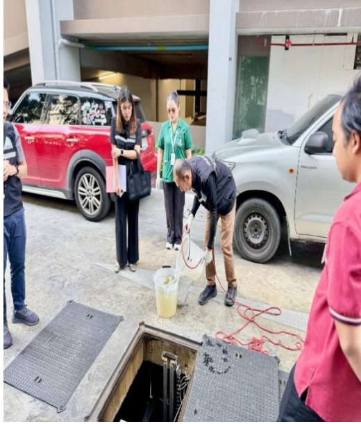
รูปที่ 3.2-2 จุดตรวจวัดคุณภาพน้ำทิ้ง คุณภาพน้ำหลังการบำบัด บริเวณจุดตรวจวัดน้ำทิ้งหลัง ออกจากระบบบำบัดน้ำเสีย ประจำเดือน ธันวาคม พ.ศ. 2568
